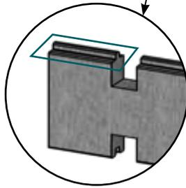
Insertar tornillos en los extremos de las lamas de soporte del coronamiento puede hacer que las lengüetas de la lama se separen.
